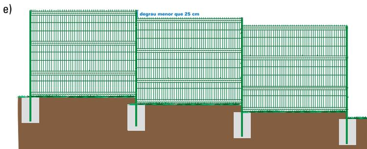
Em terrenos com desnível, antes de iniciar a instalação, é preciso analisar os níveis de inclinação da área. Recomendamos a instalação do Gradil Morlan de forma escalonada (figuras E e F). Neste tipo de instalação, deve-se usar um poste com medida imediatamente superior para evitar que a ponta superior do gradil fique solta. Os degraus devem ter no máximo 25 cm de altura.
