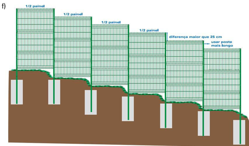
Se o desnível for muito acentuado e acarretar um degrau com mais de 25 cm de altura, recomendamos cortar o painel no sentido transversal, utilizando-se um arco de serra manual, dividindo o painel em duas partes a fim de compensar a demasiada inclinação do terreno e respeitar a altura máxima de 25 cm de altura para o degrau (este tipo de instalação requer uma quantidade maior de postes).
