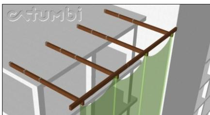
Suba o conjunto e prenda na parte superior pelas cordas e deixe a tela devagarosamente cair, para facilitar o trabalho coloque um lastro na parte inferior da tela.
