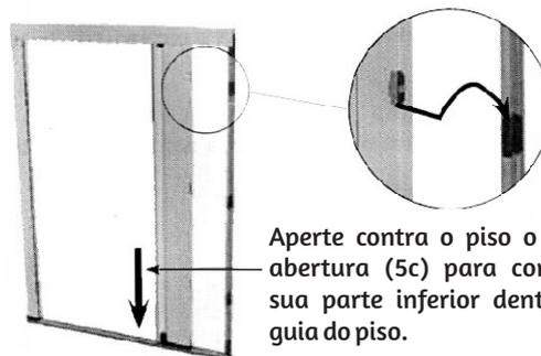
Aperte contra o piso o perfil abertura (5c) para conectar sua parte inferior dentro da guia do piso.
