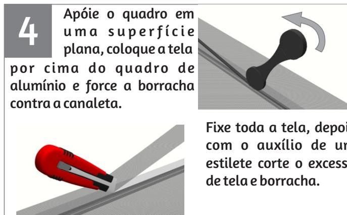
Apóie o quadro em uma superfície plana, coloque a tela por cima do quadro de alumínio e force a borracha contra a canaleta.
