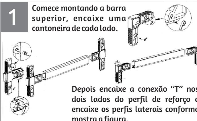
Depois encaixe a conexão "T" nos dois lados do perfil de reforço e encaixe os perfis laterais conforme mostra a figura.
