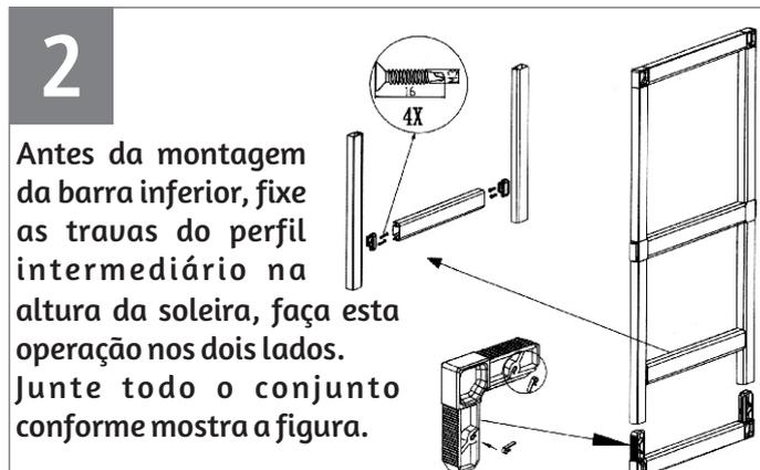
Antes da montagem da barra inferior, fixe as travas do perfil intermediário na altura da soleira, faça esta operação nos dois lados. Junte todo o conjunto conforme mostra a figura.
