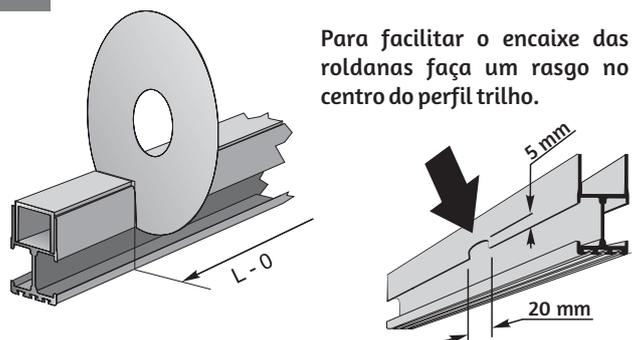
**3** Corte o perfil batente com a medida da altura descontando 49mm
