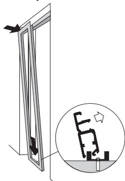
**18** em seguida encaixe as roldana dentro do perfil trilho através do rasgo existente no centro dele.
