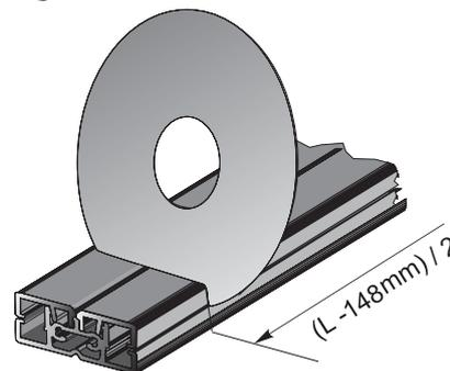
**11** Faça dois furos de Ø3mm na centro do perfil quadro vertical e fixe o perfil reforço, utilize os maiores parafusos.
