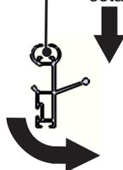
Após o desencaixe o acionamento é automático.
