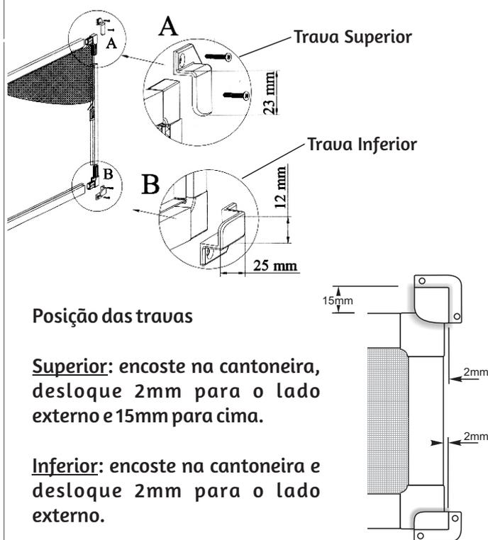
**1b** Marque na parede os quatro pontos onde serão colocadas as travas de sustentação e remoção do conjunto.
